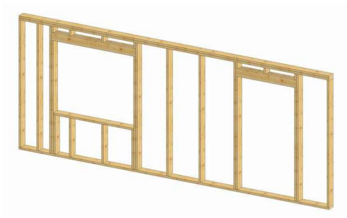
(Rys. 1) Konstrukcja ściany
